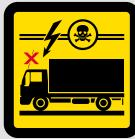
› Установка антенн под контактным проводом запрещена
